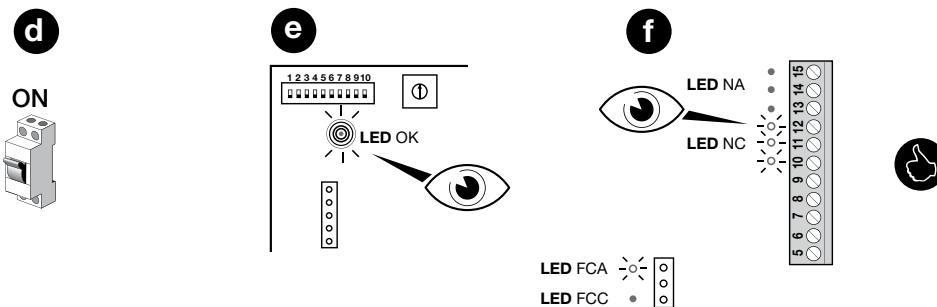
**!** Если этого не происходит, немедленно отключить подачу электропитания и внимательно проверить соединения и исправность устройств
