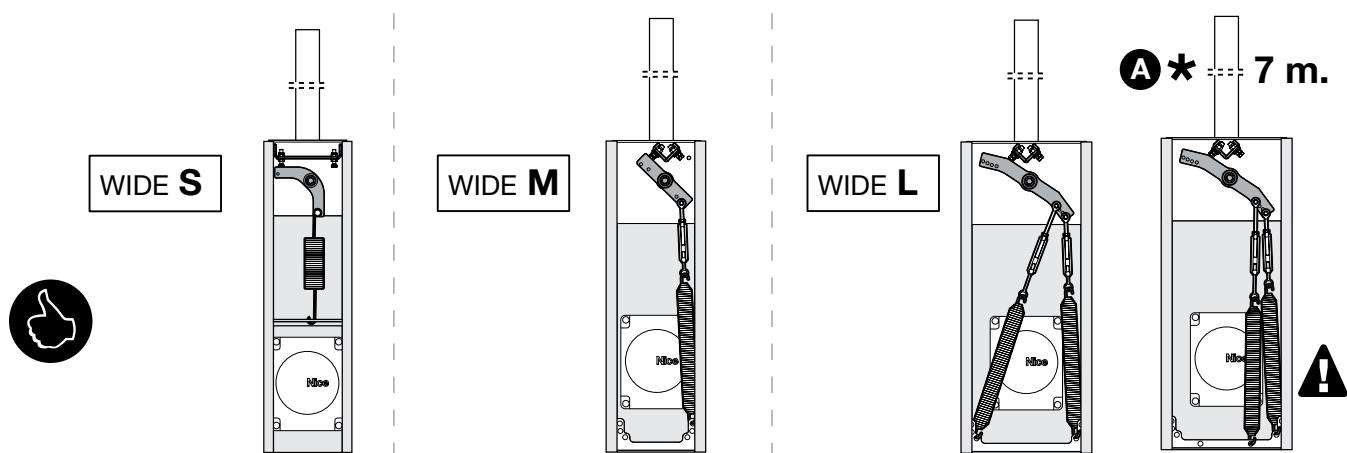
**⚠ \* Только в случае стрелы длиной 7 м установите балансировочные пружины так, как показано на рисунке «A»**
